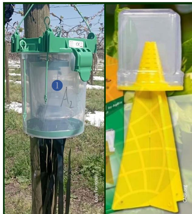
Fig. 4. Armadilhas do comércio da especialidade, utilizadas para a monitorização e/ou captura em massa do percevejo asiático. A armadilha marcada com 1 possui um mecanismo de vibração alimentado por um painel solar.
